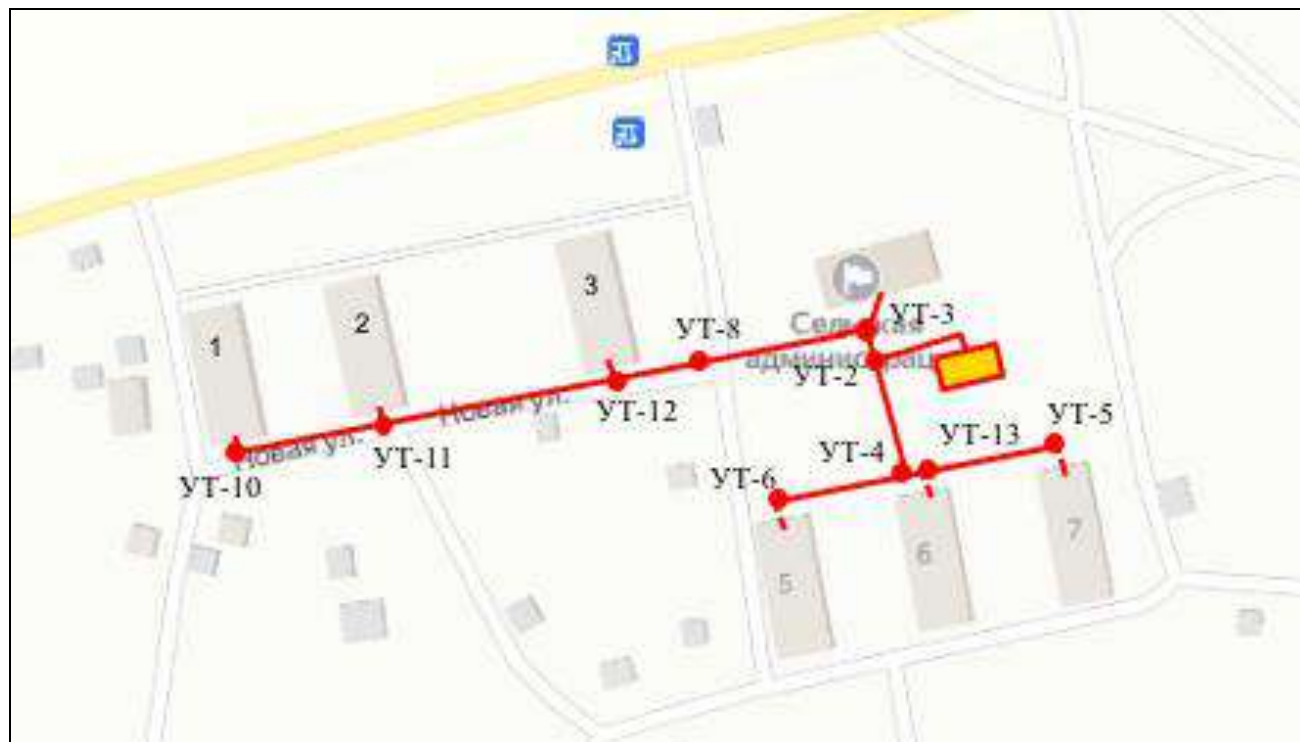
Рисунок 2.2.5 – Схема тепловых сетей котельной д. Просек
